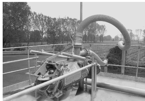
Il separatore a compressione elicoidale garantisce un prodotto separato con un elevato tenore di S.T.
