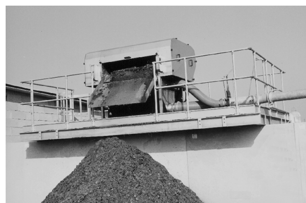
Il separatore a rulli pressori garantisce elevata produttività e bassi consumi energetici anche nei liquami ricchi di paglia.
