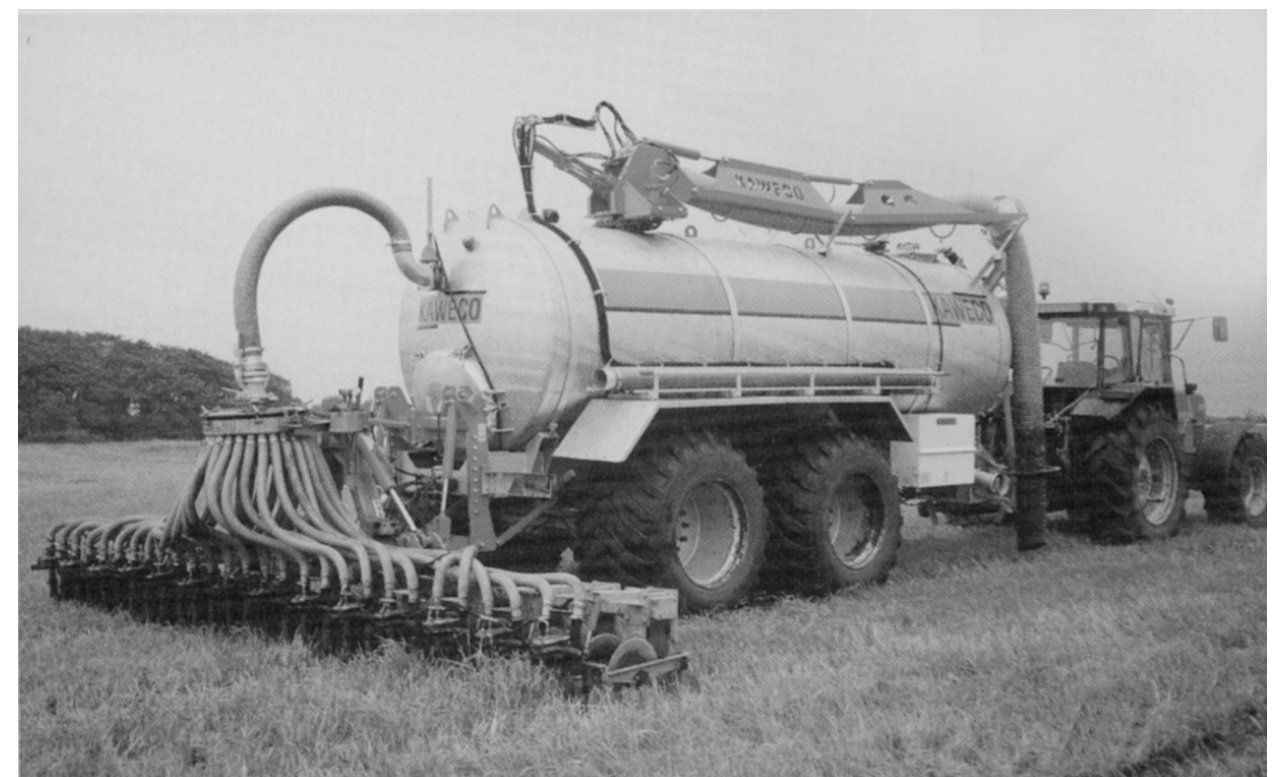
Il distributore-ripartitore di portata garantisce una elevata uniformità di prodotti distribuiti.
