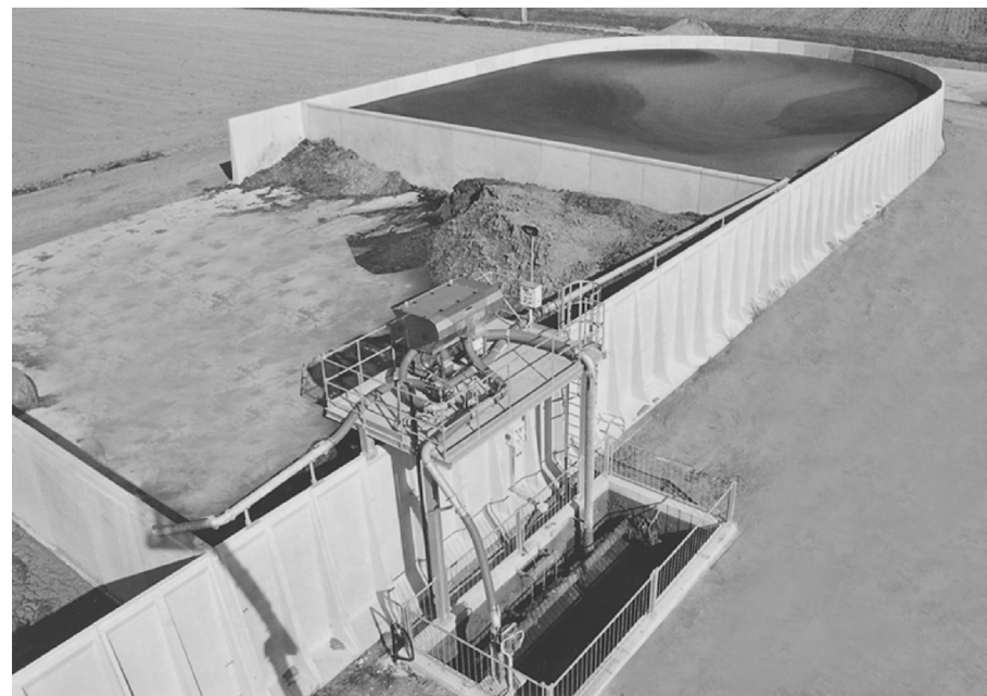
Il trattamento di separazione dei solidi consente un più facile stoccaggio e una migliore gestione dei liquami.
