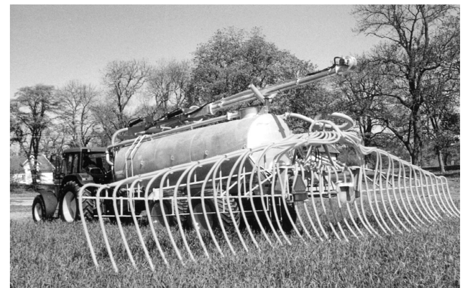
La distribuzione per strisciamento consente buona precisione e riduzione delle emissioni.
