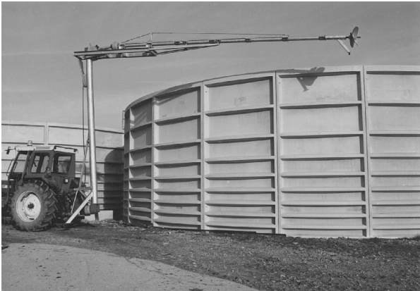
La miscelazione prima della distribuzione assicura una uniforme concimazione delle colture.
