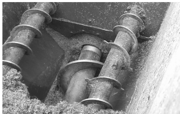
Coclee laterali di miscelazione e coclea di fondo poste nella tramoggia di carico per l'immissione della biomassa.
