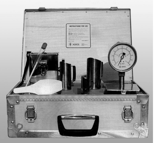
La determinazione del contenuto di azoto dei liquami attraverso kit rapidi di misura è essenziale per la loro corretta utilizzazione agronomica.
