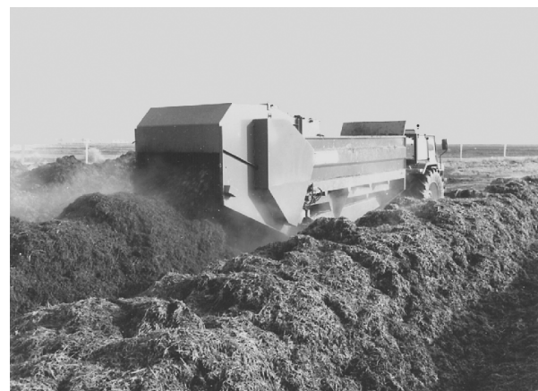
Il trattamento di compostaggio in platea richiede l'uso di speciali carri trituratori andanatori.
